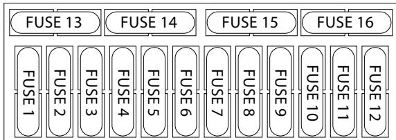
**ATTENZIONE. Rischio di esplosione.** Utilizzare solo fusibili conformi a SAE J1171 (protezione anti-innesco). I fusibili/interruttori con protezione da sovraccorrente sono da 30 A e si trovano accanto al sezionatore batteria.
