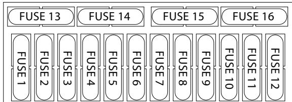
**ADVERTENCIA. Riesgo de explosión.** Únicamente utilice fusibles compatibles con SAE J1171 (protección durante el encendido). Los fusibles/llaves térmicas de protección contra sobrecorriente tienen una capacidad de 30 amperios y se encuentran junto al aislador de la batería.
